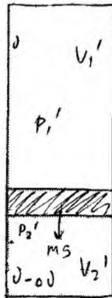
$$2) \frac{P_1' V_1'}{P_2' V_2'} = \frac{J RT}{(J - \Delta U) RT}$$
